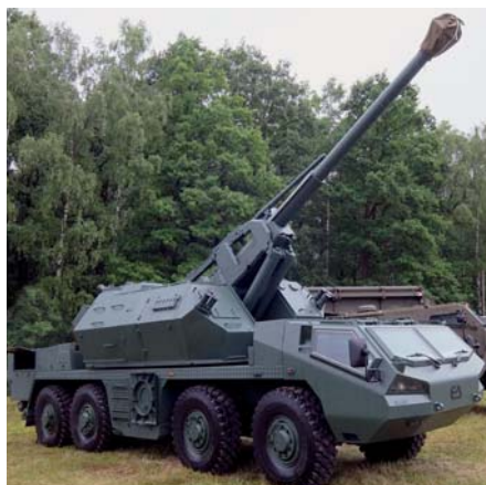
Houfnice DANA M2 s novou kabinou na úrovni ochrany M1 dle STANAG 4569
