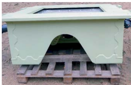
Zkušební vzorek dna kabiny před osazením do zkušebního stavu
