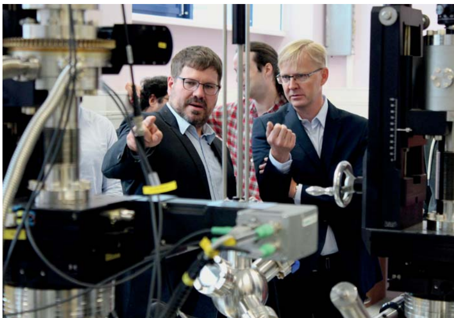
Přístroj SARPES – fotoelektronový emisní spektrometr se spinovým a úhlovým rozlišením, který používají vědci ve vysokoškolském ústavu ZČU Nové technologie – výzkumné centrum (vlevo prof. Ján Minár)
