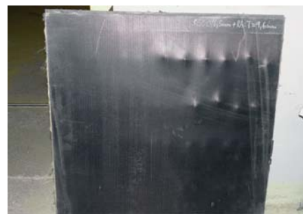
Čelní a zadní strana vzorku 2 po nástřelech náboji 5,56 mm x 45 NATO se střelami M 193
