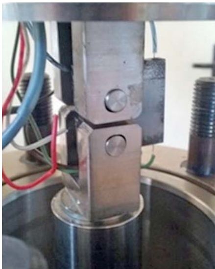
Obr. 3: Detail zkušební tělesa před měřením rychlosti šíření únavové trhliny v prostředí vysokotlakého vodíku
