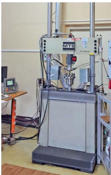
Obr. 1: Pracoviště vodíkového autoklávu v laboratoři MMV
