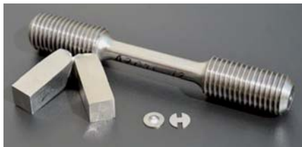
Porovnání velikosti standardního a miniaturního vzorku na zkoušku tahem
