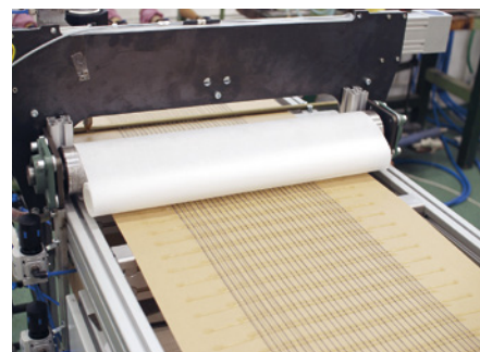
Prototypové zařízení na výrobu textilní struktury pro 3D nosiče šneky
