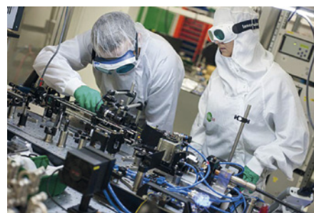
Experimentální sestava pro přesné měření zakřivení povrchu tenkých laserových krystalů
