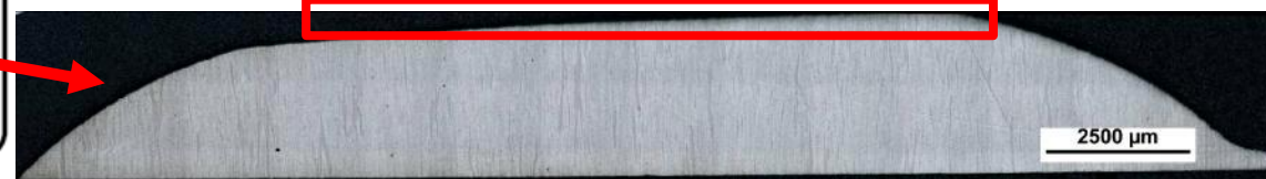
Analýza ovlivněné vrstvy – oduhličení do 15 μm
