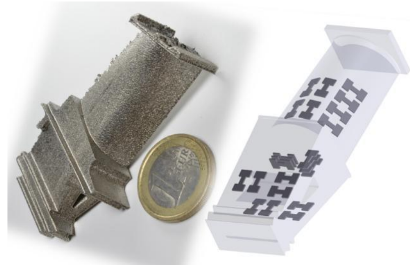
Výzkum vlastností pomocí M-TT na lopatce z Inconelu 718 po 3D tisku
