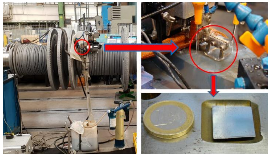
Odběr z rotoru na několika místech, pohled na detail odběru a finálně odebraný lodičkový vzorek
