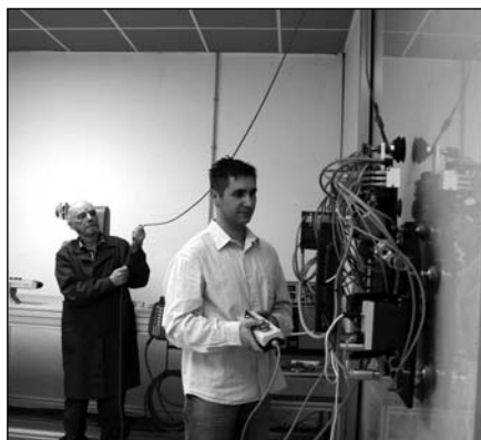
Robot leze po stěně, rádiem ho řídí Vlastimil Hotař, pro jistotu je ještě jištěn lanem
