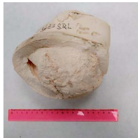
Odpady porézní polymerní hmoty – zbytek z nádoby po odlévání formy
