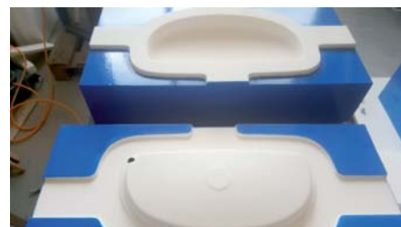
Formy z vyvinuté lící hmoty s obsahem recyklátu
