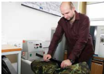
Roman Knížek u přístroje Textest FX 3300 při měření prodyšnosti bundy
