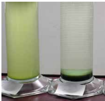
Voda kontaminovaná sinicemi (vlevo) a vyčištěná voda několik hodin po aplikaci nanoželeza (vpravo). Zabitě a rozložené buňky sinic sedimentují na dně.
