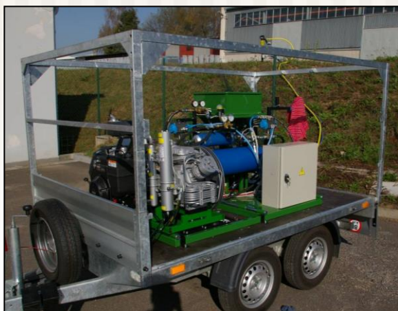
Prototyp tlakové injektáže
