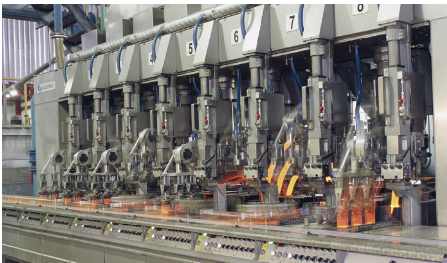
Automatizovaná výroba skla – Řadový stroj pro výrobu obalového skla s vysokou flexibilitou a produktivitou, zařízení dokáže vyrábět až 54 000 kusů za hodinu (při čtyřkape a 12 sekcích), zdroj: Sklostroj Turnov CZ, s.r.o.
