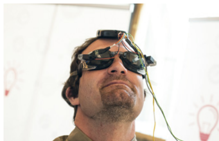
Orbitopletysmograf – zařízení na bezkontaktní snímání tlakových změn (Zdroj: UK, René Volfík)
